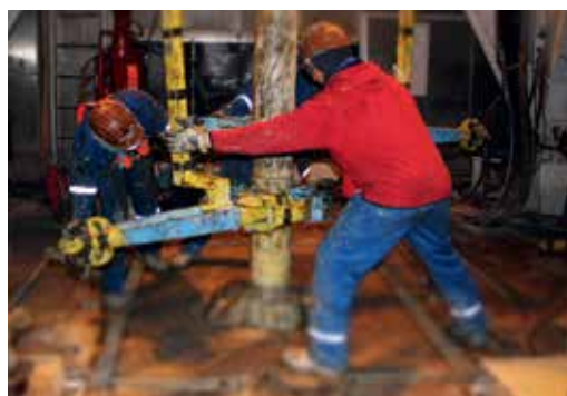
La machine de forage à Arcueil, d'une hauteur de 40 mètres, a été installée en octobre 2013. Le forage des deux puits géothermiques à 1 600 mètres de profondeur s'est déroulé de novembre 2013 à mars 2014.
