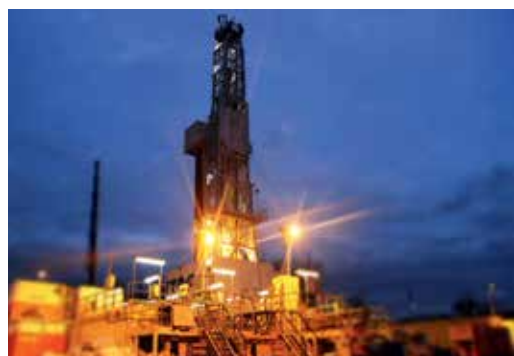
La machine de forage à Arcueil, d'une hauteur de 40 mètres, a été installée en octobre 2013. Le forage des deux puits géothermiques à 1 600 mètres de profondeur s'est déroulé de novembre 2013 à mars 2014.
