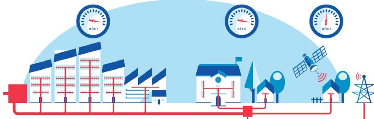
Les réseaux de fibre optique jusqu'à l'abonné (FTTH pour « Fibre to the Home ») permettent de bénéficier des avantages de la fibre optique sur l'ensemble de la ligne (très haut débit, stabilité du signal, symétrie pour tous les usagers concernés).
