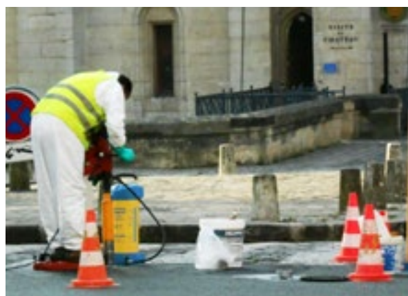
Prélèvement d'un échantillon d'enrobé de voirie.
