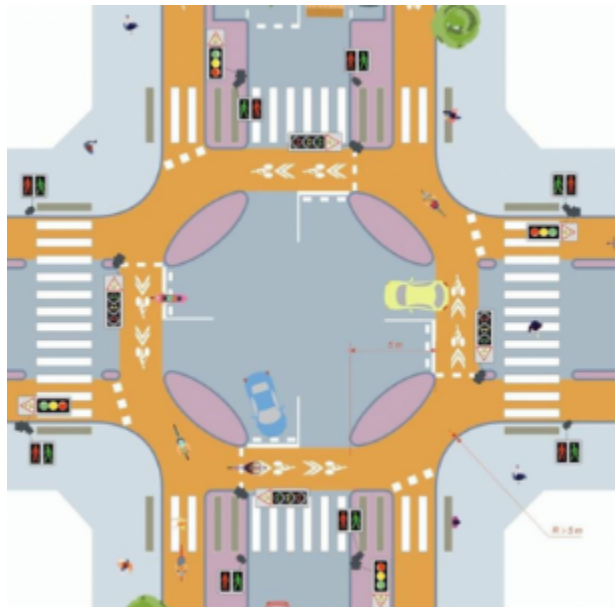
Schéma de principe d'un carrefour « à la Hollandaise ». Source : CEREMA
